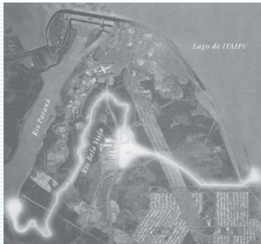
Figura 6.1.9 - Canal de Piracema de Itaipu, um canal secundário para a transposição de peixes (Fonte: Itaipu Binacional).
